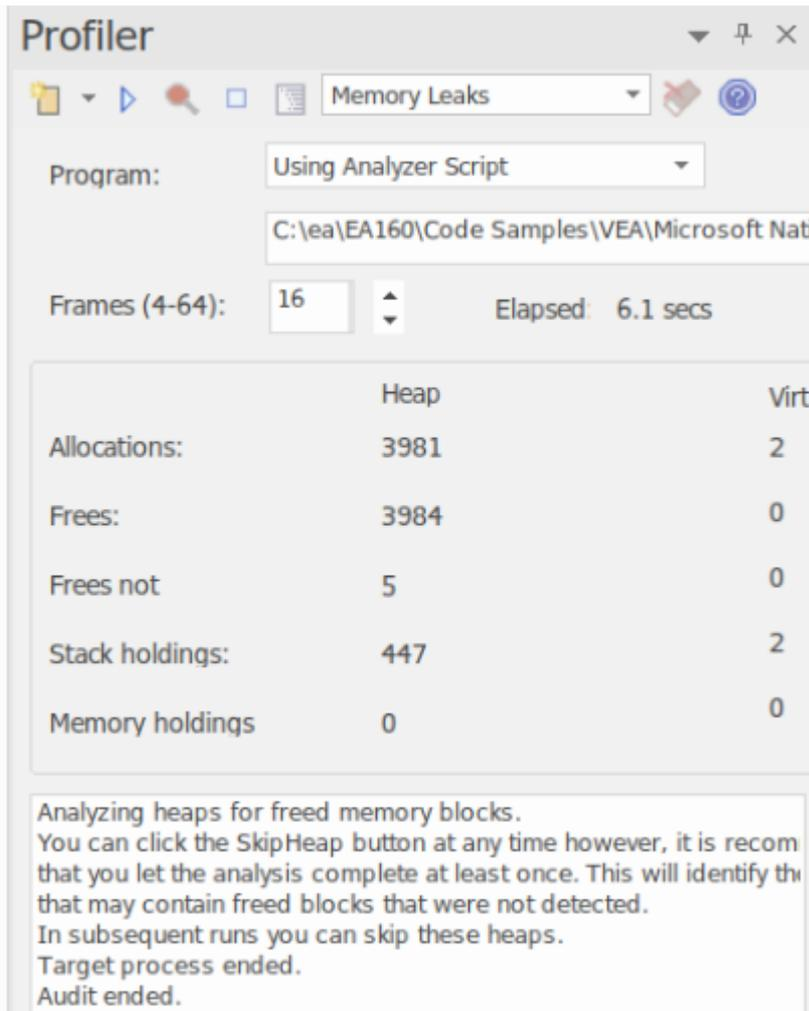
Profiler 控件，显示内存分配计数和可用内存操作的计数。
