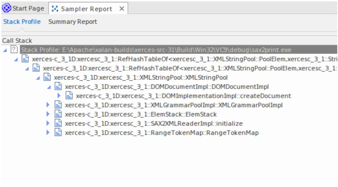
堆栈Profiles用于发现在程序运行期间调用特定函数的不同方式（堆栈）和方式计数。与其他分析器模式不同，此配置文件是通过使用配置文件点激活的，这是一种特殊的断点标记。标记像任何其他断点一样设置在源代码中。当程序遇到断点时，堆栈被捕获。当您稍后生成报告时，会分析堆栈并生成加权调用图。该图显示了在分析器运行期间该函数所涉及的唯一堆栈，“命中计数”列表表示相同堆栈发生的次数。
