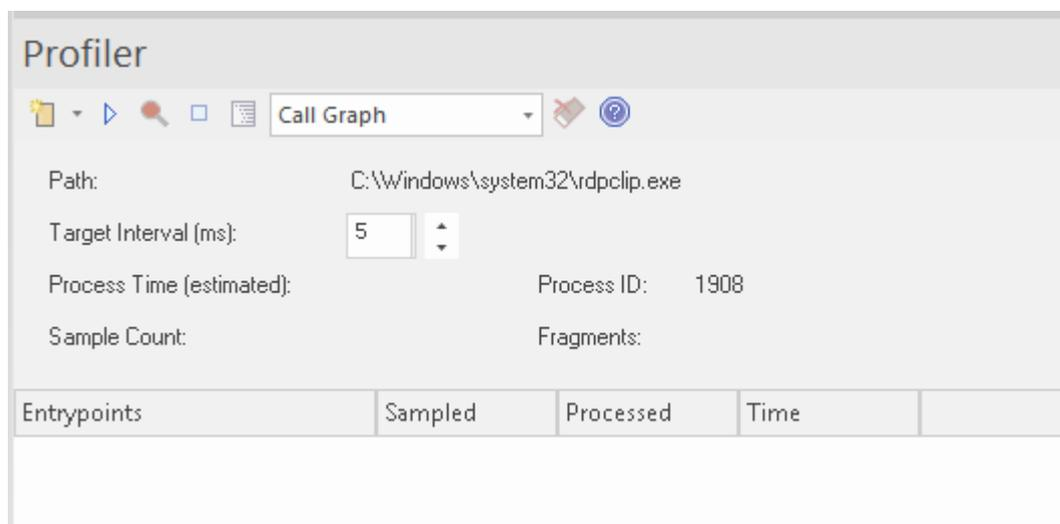
Profiler 使用其工具栏按钮进行控制。在这里，您可以将 Profiler 附加到现有进程（或 JVM），或为活动的分析器脚本应用程序。Profiler 窗口显示目标进程的详细信息，因为它被分析。这些详细信息提供反馈，让您查看采集的样本数量。您还可以选择暂停和恢复捕获、清除捕获的数据和生成报告。您可以通过暂停捕获来访问报告特征- 在数据捕获过程中报告特征被禁用。
