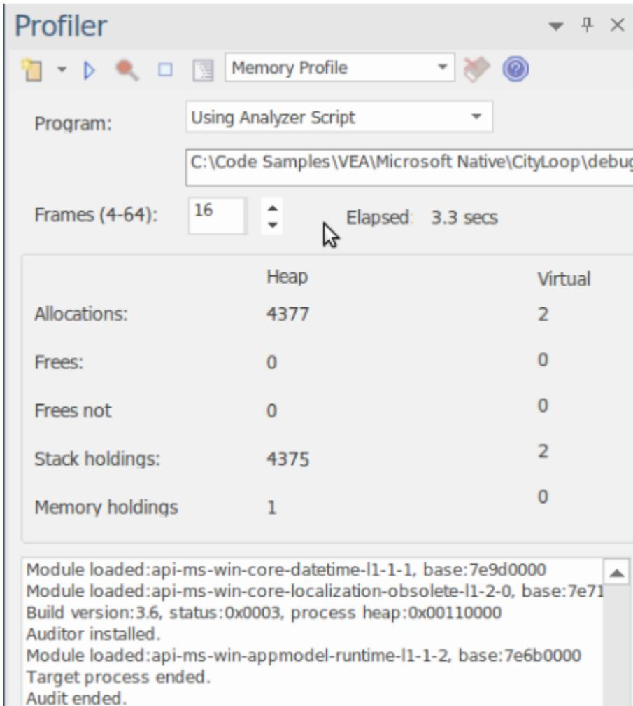
内存配置跟踪分配，忽略内存何时释放。它使用此信息来评估执行代码对内存的需求，而不是内存量，而是需求频率。 *Allocations* 数字是请求的内存分配总数。 *Stack Holdings* 是在那些时间进行的堆栈跟踪的数量，而 *Heap Holding* 数字是这些调用获得的内存总量。 注记可以按需打开和关闭分析。由于不涉及任何链接，因此也无需重建程序以使其正常工作。
