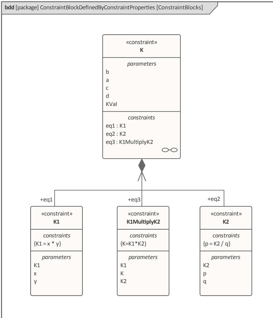
在 ConstraintBlock 'K' 中创建一个参数图，并使用捆绑连接器将参数连接到约束属性，如图所示：
